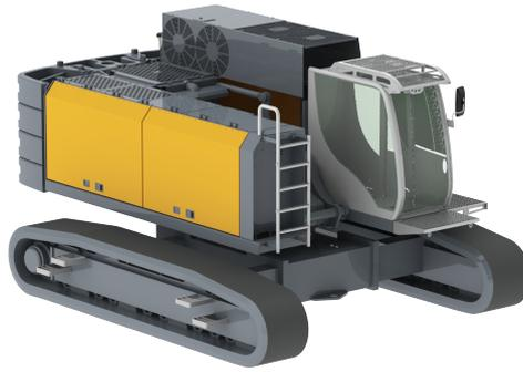
Abbildung 0.2: Trägergerät der RTG [BMA]
