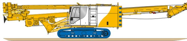
Abbildung 0.1: Transport bereite BG mit H-Mast [BMA]
